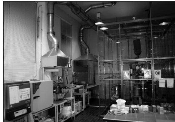
Abbildung 2: Biokohle-Technikum des ATB mit HTC-Anlagen. 1 L Reaktor (links, unter Abzug) und 18 L Reaktor (rechts, in Einhausung)
