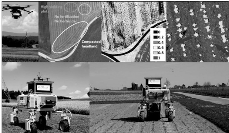
Abbildung 3: Drohne (links oben) und Feldroboter (rechts links unten), die im Rahmen des H2020-Projektes 'Flourish' autonom miteinander interagieren, um Unkrautbekämpfung sowie Bodenbearbeitung durchzuführen. Die im Original farbcodierte Karte (oben Mitte) zeigt Abstufungen des 'normalized difference vegetation index', die von 0 bis 1 reichen und zur Charakterisierung des Pflanzenbedeckungsgrades und des Düngungszustandes verwendet werden. Die im Original farbig maskierte Detailkarte (rechts oben) eines Zuckerrübenfeldes zeigt die automatische Trennung in Kulturpflanze und Unkraut, aufgrund derer der Feldroboter ortsspezifische Bekämpfungsmassnahmen durchführt.
