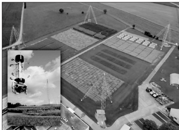
Abbildung 1: Feld-Phänotypisierungs-Anlage FIP der ETH Zürich in Lindau-Eschikon. Auf einer Fläche von ca. 1 ha können Parameter von Kulturpflanzen mit Hilfe eines Sensorkopfs bildgebend vermessen werden. Der Sensorkopf ist an Kevlar-Seilen befestigt, deren Länge durch die Ansteuerung von Winden koordiniert manipuliert wird. Dadurch kann der Sensorkopf jeden Punkt über dem Feld erreichen. Die Höhe der vier Masten beträgt 24 m. Derzeit werden Weizen (zwei Schläge), Soja, Mais, Buchweizen und Rotklee auf dem Feld angebaut und nach Regeln guter landwirtschaftlicher Praxis in einer Fruchtfolge bewirtschaftet.
