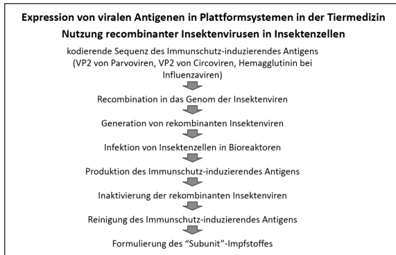
Abbildung 4: Schematische Darstellung zur Herstellung eines Subunit-Impfstoffes mittels rekombinanter Baculoviren
